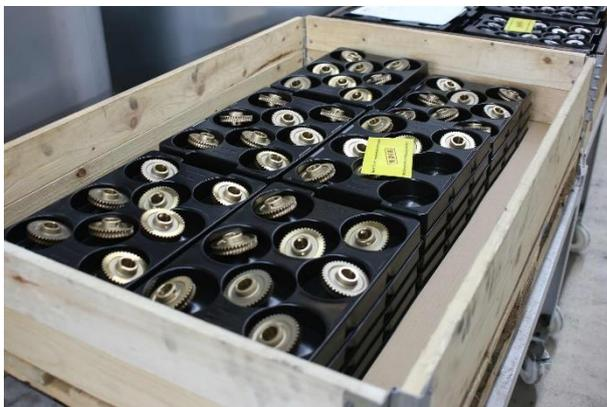
Antriebe mit optimalen Eigenschaften erfordern Spezialkonstruktionen und damit eine hohe Fertigungstiefe. Hier Messingzahnräder für Schneckengetriebe.
