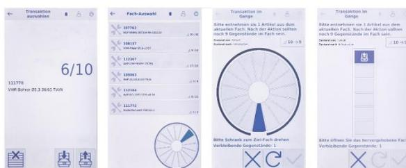
Die Bedienung ist einfach: Nach Auswahl der gewünschten Transaktion wird die Trommelposition angezeigt. Nach Eindrehen der Trommel von Hand wird das Fach durch einen blauen Lichtbalken markiert und kann geöffnet werden. Abschließend ist die Transaktion zu quittieren.
